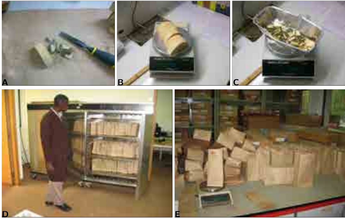
PHOTO 3.8 – Mesures en laboratoire: (A) écorçage des rondelles, (B) pesée du bois, (C) pesée de l'écorce (photos: L. Saint-André), (D) mise à l'étuve des échantillons, (E) pesées régulières jusqu'à stabilisation du poids (photos: M. Henry).
