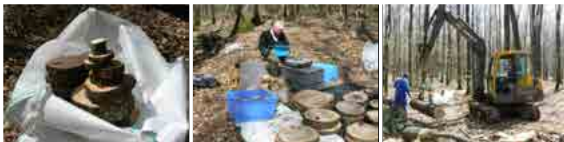
PHOTO 3.7 – Campagne de biomasse dans une chênaie. À gauche les rondelles prélevées pour un arbre et positionnées dans leur big-bag avant transport vers la zone de pesée des échantillons; au milieu zone de pesée des échantillons; à droite mise en œuvre de la pelleteuse pour la pesée des billons (photos: C. Nys).
