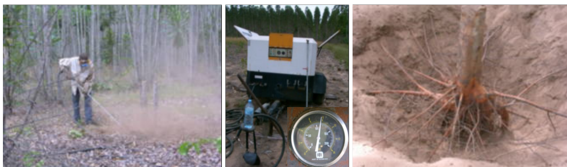
FOTO 3.12 – Utilización de un compresor de aire en el Congo para la extracción de los sistemas radiculares (raíces grandes y medianas) de eucaliptos. A la izquierda, el operador con los equipos de seguridad (protección contra el polvo y el ruido); en el centro, el compresor y una imagen ampliada del medidor que indica la presión del aire (unos 8 bares); a la derecha, el resultado (Fotos: C. Jourdan).
