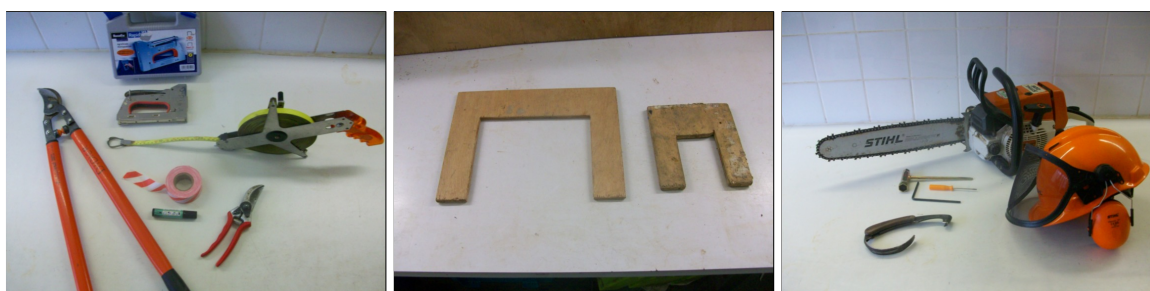
FOTO 3.13 – Material de campo. A la izquierda, material para cortar las alícuotas y etiquetarlas; en el centro, ejemplos de plantillas para cortar las ramas; a la derecha, motosierra y equipo de seguridad (Foto: A. Genet).
