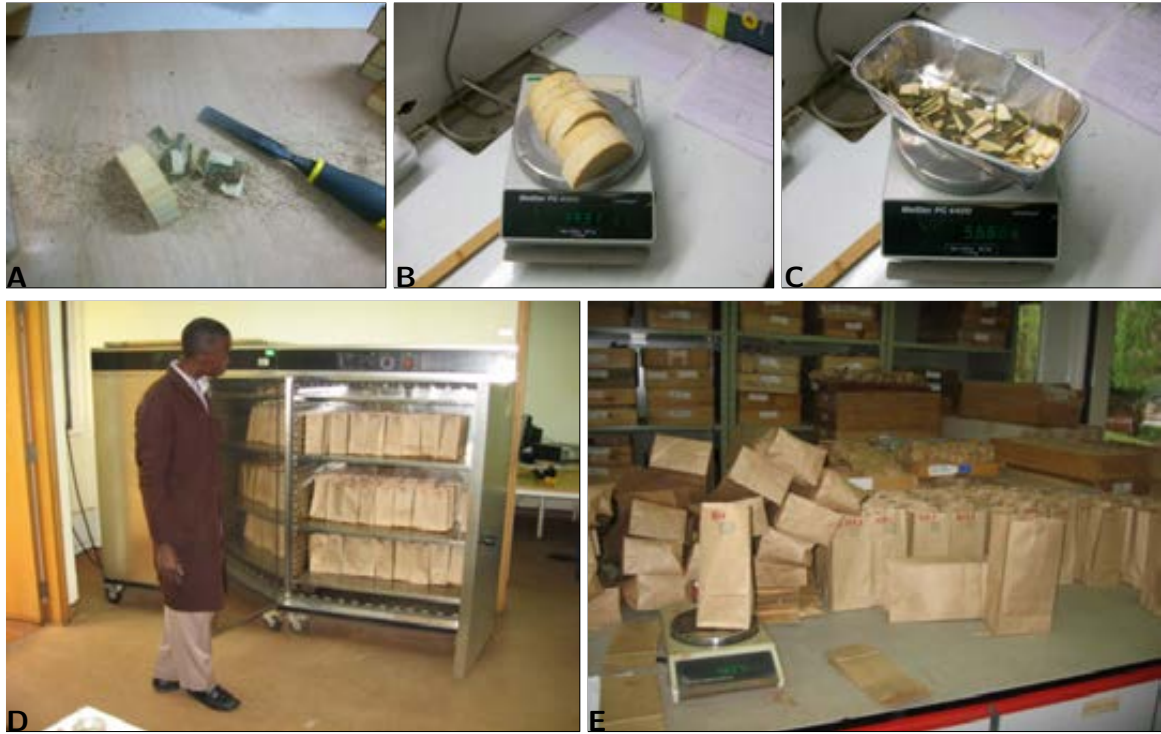
FOTO 3.8 – Mediciones en el laboratorio: (A) descortezado de las rodajas, (B) pesado de la madera, (C) pesado de la corteza (Fotos: L. Saint-André), (D) secado de las muestras, (E) pesado periódico hasta la estabilización del peso (Fotos: M. Henry).
